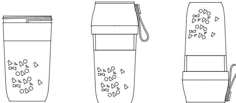
Нажмите последовательно два раза на кнопку включения и переверните блендер. Не включайте уже перевернутый блендер, так как может возникнуть перегрузка. Для более равномерного смещивания можно встряхнуть продукты в блендере. В некоторых случаях надо постоянно встряхивать продукты, как в шейкере, для лучшего приготовления.
