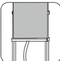
Закрепите нижнюю часть гладильной доски. Для этого выдвиньте крепления, которые находятся в нижних зажимах телескопических стоек.
