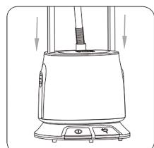
Вставьте в боковые гнезда в корпусе отпаривателя обе телескопические стойки до упора, при этом они зафиксируются.
