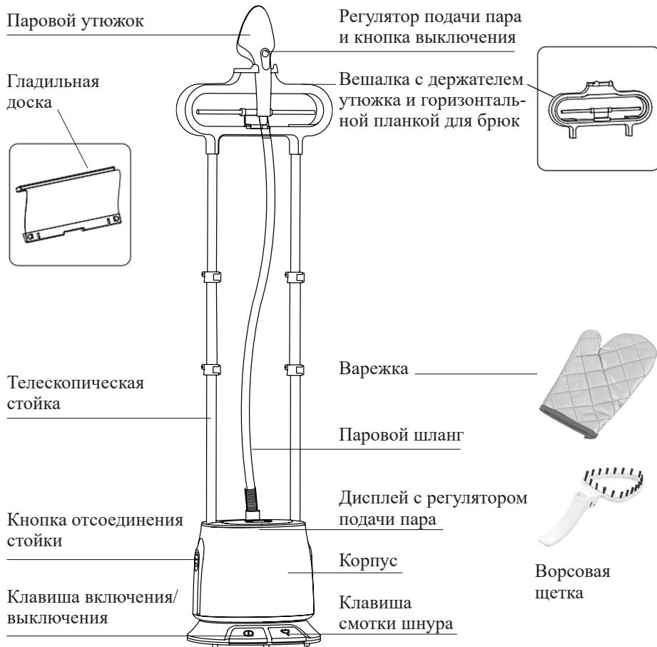
Отпариватель имеет 5 уровней подачи пара. Съемный резервуар для воды позволяет легко залить воду. Телескопическая стойка двойная, что обеспечивает дополнительные жесткость и устойчивость. Имеется держатель утюжка и горизонтальная планка на вешалке. Шнур электропитания автоматически сматывается при нажатии на педаль. В комплекте идут гладильная доска, защитная варежка и ворсовая щетка. Гладильная доска выполнена из сетки, чтобы пар легко проходил сквозь нее.
