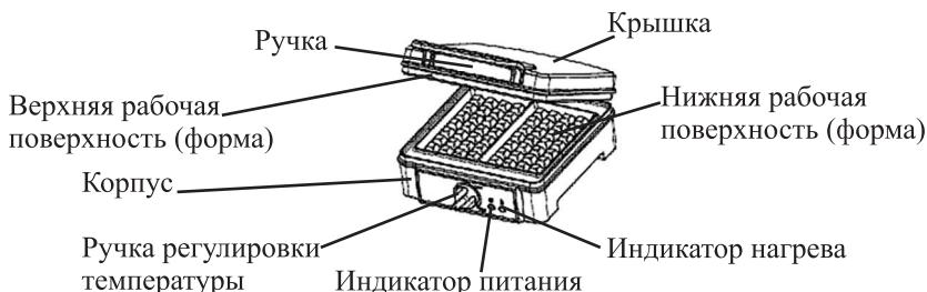
Индикатор питания (красный) горит когда прибор включен в сеть. Индикатор нагрева (зеленый) горит в то время, когда вафельница разогревается. Когда рабочие поверхности достигнут температуры, определяемой термостатом, нагрев выключится, и индикатор нагрева погаснет. Затем нагрев будет периодически включаться для поддержания температуры. Таким образом, в процессе приготовления индикатор нагрева периодически загорается и гаснет.
