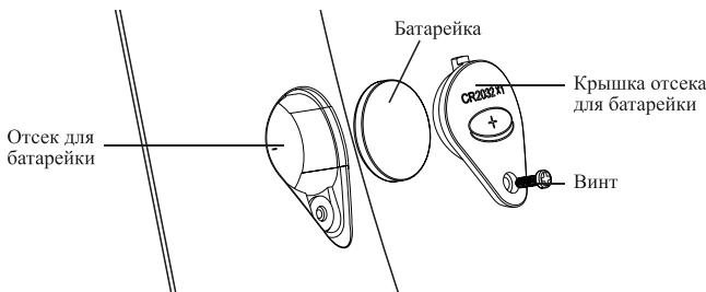
В лампе установлена батарейка CR2032 для отображения времени и температуры, и чтобы настройки часов и будильника не сбрасывались при повторном включении.
