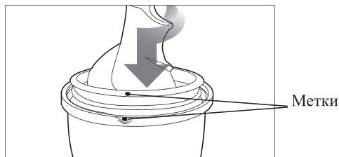
5. Установите крышку, совместив метку на ней с меткой на чаше. Затем поверните крышку по часовой стрелке до упора для фиксации.
