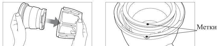
4. Установите шнек в чашу. При установке слегка нажимайте на него и поворачивайте, пока он не встанет на место до упора.
