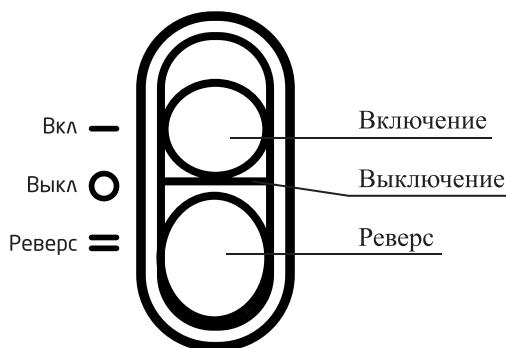
**Внимание!** Запрещается переключать соковыжималку на реверс сразу из рабочего режима, в противном случае может произойти порча двигателя или перегорит предохранитель. Перед включением реверса выключите соковыжималку, подождите, пока вращение полностью остановится, и только затем включайте реверс.
