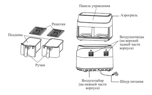
Принцип работы аэрогриля основан на конвекции воздушных потоков от нагревателей внутри рабочей емкости. Вентиляторы, расположенные в верхней части аэрогриля, приводят в движение воздушные массы, нагретые до высокой температуры ТЭНами (трубчатыми электронагревателями). Горячий воздух циркулирует внутри рабочей емкости аэрогриля и нагревает продукты до нужной температуры.
