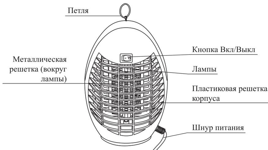
При включении за пластиковой решеткой устройства загораются две газоразрядные лампы, которые приманивают насекомых ультрафиолетовым светом.
