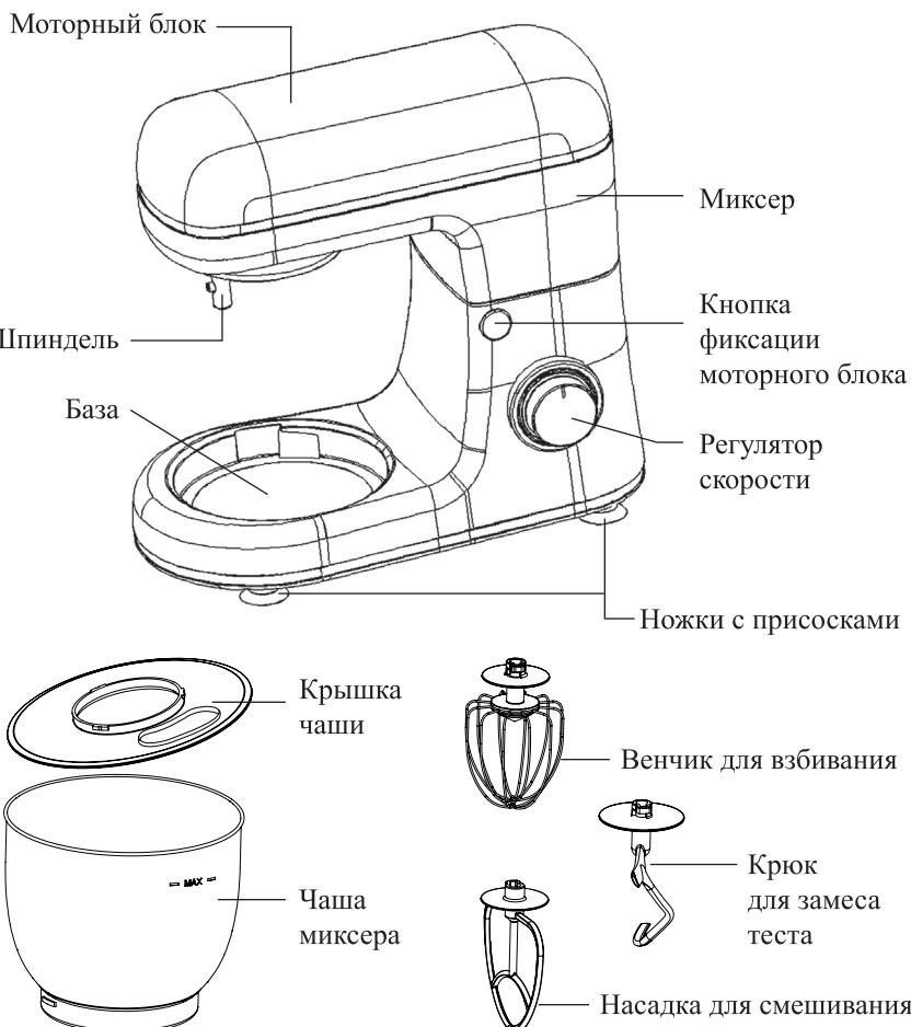
**Кнопка фиксации моторного блока** позволяет поднять и опустить моторный блок.
