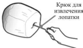
**Внимание!** Если лопатка осталась на оси в форме и не снимается, не штатайте перемешивающую лопатку из стороны в сторону, когда вынимаете ее из формы. Если лопатка не вынимается, залейте в форму теплую воду на полчаса, а затем аккуратно снимите лопатку со стержня.
