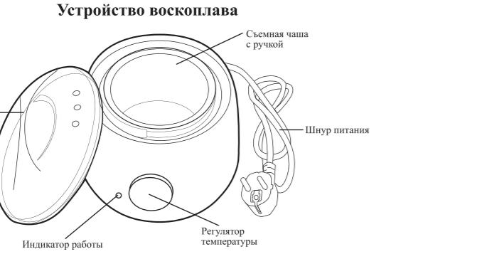
Поворот **регулятора температуры** по часовой стрелке включает прибор. При этом загорается **индикатор работы**, он горит, когда устройство включено.
