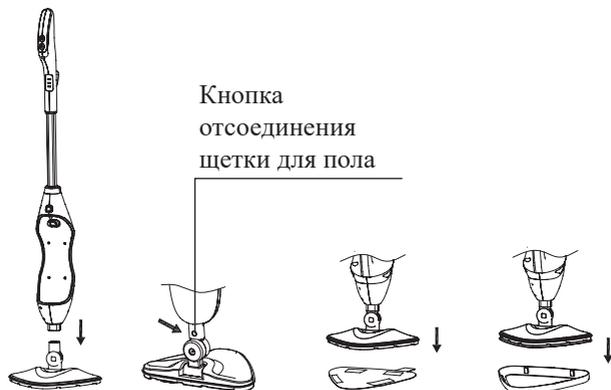
**Ручной модуль** можно отсоединить от базы и использовать отдельно. Для его отсоединения нажмите на кнопку отсоединения ручного модуля и потяните его за ручку. Для подсоединения ручного модуля вставьте его в базу до щелчка.
