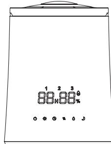
9. Нажмите на кнопку «Ночник». При первом нажатии на кнопку «Ночник» включится декоративная подсветка — крышка резервуара начнет подсвечиваться изнутри разными цветами, второе нажатие на кнопку зафиксирует один цвет, кнопка при этом загорится зеленым цветом. Третье нажатие на кнопку отключает функцию — кнопка загорается красным цветом.
