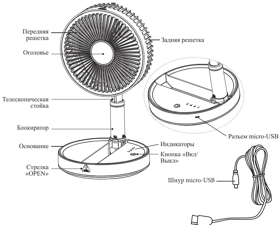
**Индикаторы** загораются при выборе скорости или режима работы вентилятора, а также показывают уровень заряда аккумулятора во время работы и зарядки устройства. Горит один индикатор — низкий уровень заряда, горят все четыре индикатора — батарея полностью заряжена.
