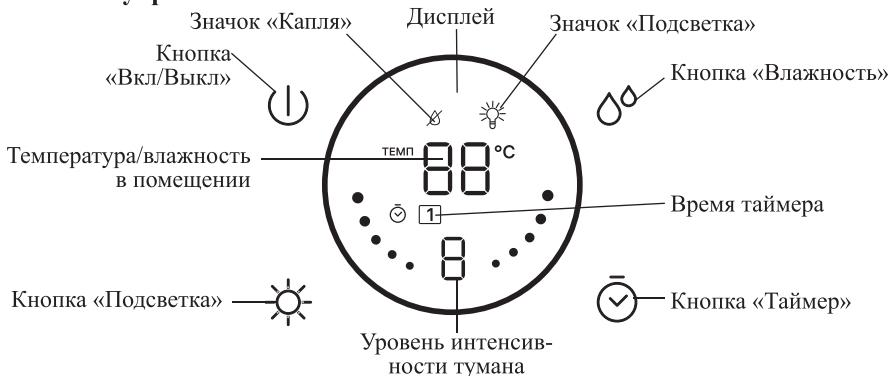
Управление увлажнителем происходит сенсорными кнопками или пультом дистанционного управления (пульт ДУ). На дисплее отображаются температура и влажность в помещении, уровень интенсивности тумана, время таймера, значок «Подсветка» и значок «Капля».
