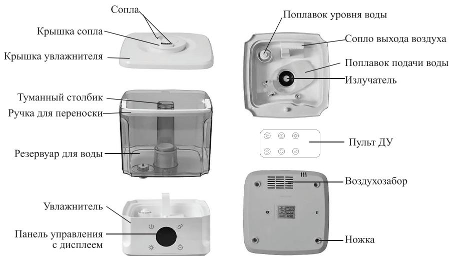
Поворачивайте **крышку сопла** для изменения направления потока тумана. Крышку сопла можно крутить на 360°. Второе сопло неподвижно и выдувает в одном направлении.
