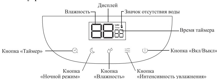
**Кнопка «Вкл/Выкл»** включает и выключает увлажнитель. При нажатии кнопки «Вкл/Выкл» увлажнитель включается на максимальной интенсивности увлажнения, на дисплее отображается текущий уровень влажности в помещении (%).
