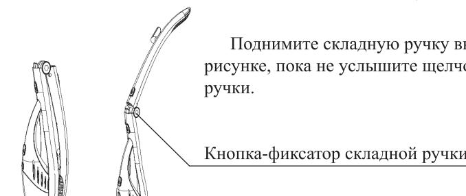
Поднимите складную ручку вверх, как показано на рисунке, пока не услышите щелчок кнопки-фиксатора ручки.
