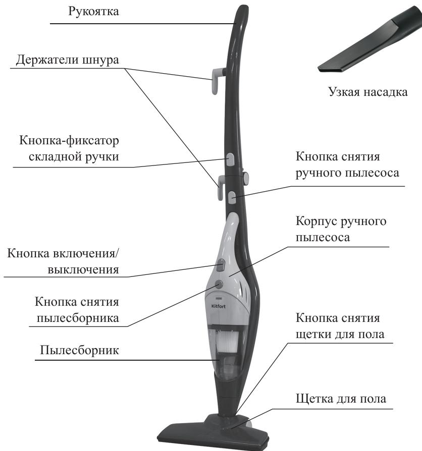
**Кнопка Включения/Выключения** расположенная на рукоятке ручного пылесоса при одном нажатии включает работу пылесоса, при повторном выключает. Далее по тексту кнопку Включения/Выключения будем называть «Вкл/Выкл».
