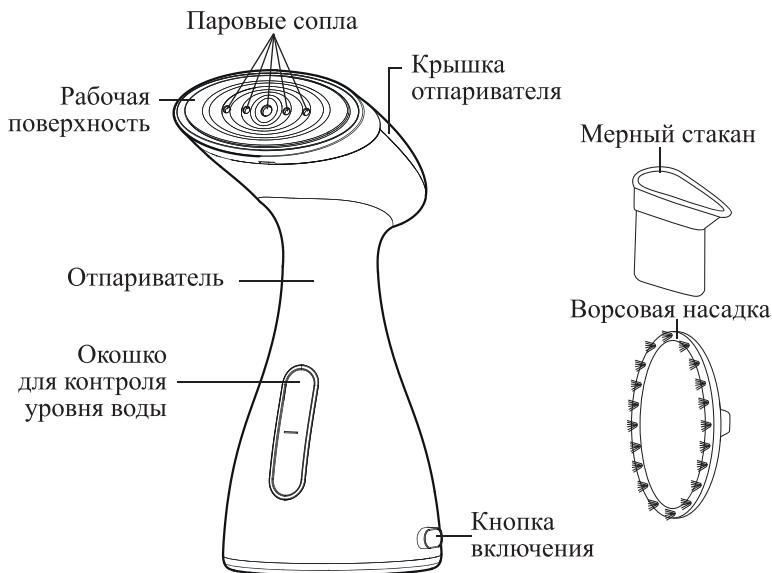
**Ворсовая насадка** предназначена для очистки одежды от грязи и шерсти домашних животных. Шерсть прилипает к одежде из-за статического электричества, и ее довольно проблематично счистить. Пар снимает с шерсти электрический заряд, и она легко счищается ворсовой насадкой.
