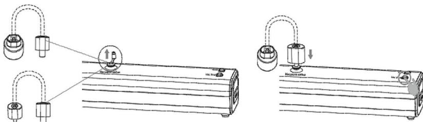
Надавите рукой на крышку контейнера, чтобы плотно ее прижать. После того, как часть воздуха удалится, крышка будет прижиматься атмосферным давлением. Если при вакуумировании слышен свист или шипение, это значит, что в каком-то месте крышки неплотно прижата или под уплотнитель попал посторонний предмет.
