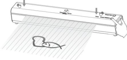
Подождите 2–3 секунды, чтобы шов застыл, затем потяните за клапан напуска воздуха, чтобы в вакуумную камеру попал воздух. Откройте крышку и выньте упакованный пакет.
