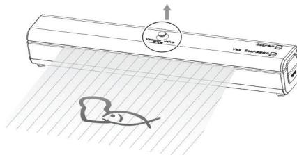
Перед следующим вакуумированием сделайте перерыв на 40 секунд для охлаждения запечатывающего элемента.
