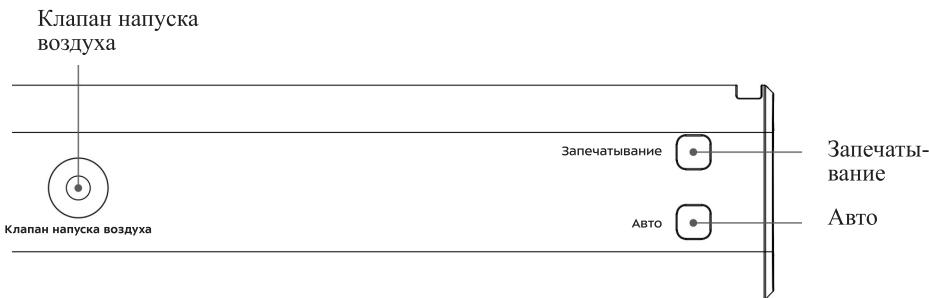
**Запечатывание** — при нажатии кнопки начинается запечатывание шва пакета. Повторное нажатие на кнопку прерывает запечатывание.
