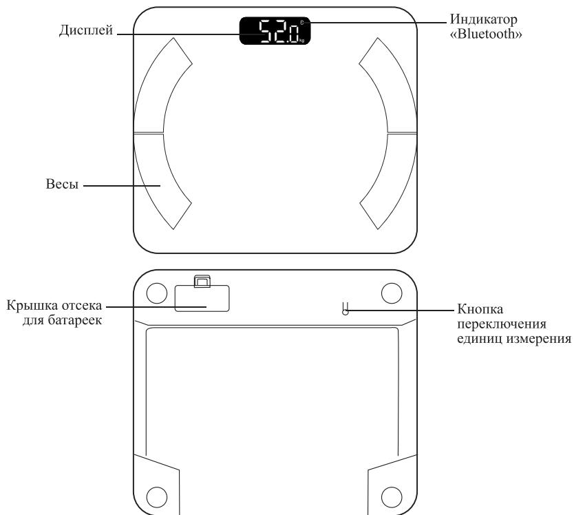
Весы автоматически включаются, когда вы встаете на них. На *дисплее* отображается вес, выбранная единица измерения и *индикатор «Bluetooth»*. Индикатор «Bluetooth» горит всегда, когда устройство включено.
