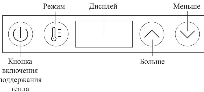
На базе находятся сенсорные кнопки для выбора температурного режима и настройки температуры нагрева. Нажатие на кнопки сопровождается звуковым сигналом.
