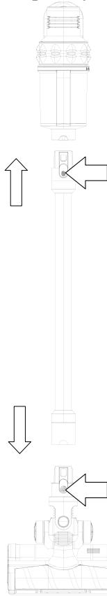
Вставьте удлинительную трубку до щелчка в щетку для пола, соединив контакты на трубке и на щетке. Аналогичным образом присоедините удлинительную трубку к всасывающему отверстию пылесоса.
