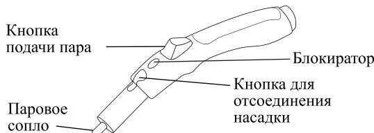
**Кнопка подачи пара** расположена сверху на пистолете и может блокироваться **блокиратором**. Всегда включайте блокировку при смене насадок, а также в перерывах в работе, чтобы исключить случайную подачу пара.
