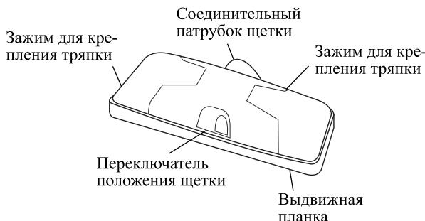
Для присоединения **переходника к щетке для пола** необходимо совместить выступ в разъеме щетки и прорезь на патрубке переходника (переходник при этом будет повернут вниз), а затем вставить переходник и повернуть его на 180° в рабочее положение.
