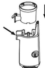
4. Вставьте шнек в чашу, поверните его по часовой стрелке до упора. При установке слегка нажимайте на него и поворачивайте по часовой стрелке, пока он не встанет на место до упора.
