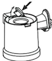
3. Переверните чашу и установите ее на моторный блок таким образом, чтобы носик для выхода жмыха попал в прямоугольную прорезь на моторном блоке.
