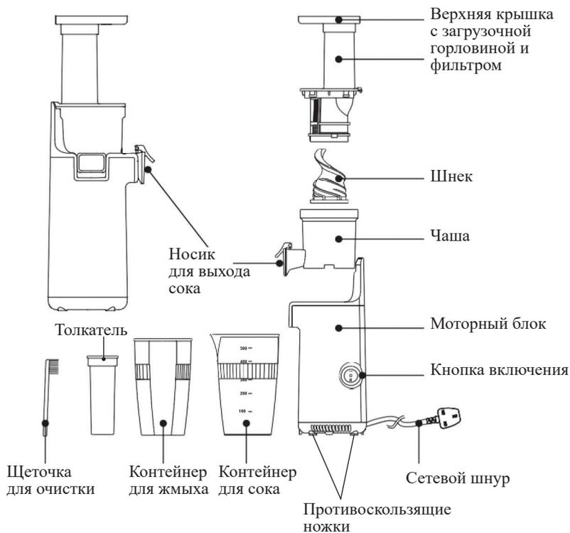
Соковыжималка оснащена переключателем безопасности, который блокирует кнопку включения, если соковыжималка собрана неправильно.
